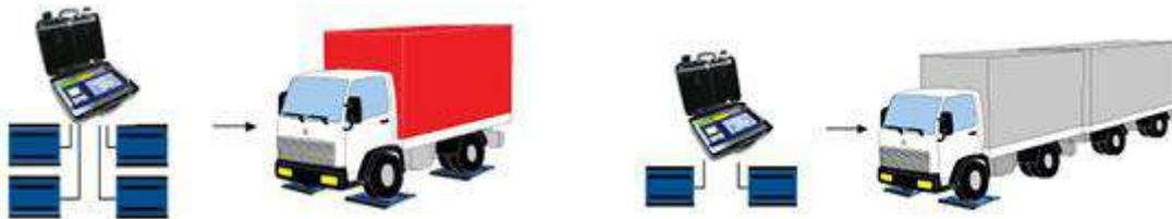
Pesado de la rueda con la balanza para vehículos      Pesado del eje con la balanza para vehículos
