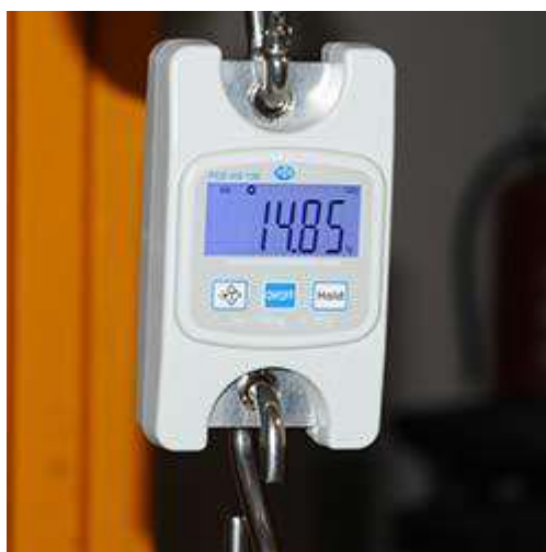
La pantalla de la balanza de gancho digital de la serie PCE-HS mientras pesa.
