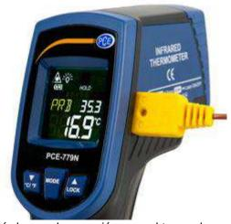
Aquí observa la conexión para el termoelemento que está situada en la parte lateral del termómetro infrarrojo.
